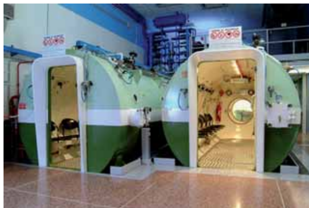
ATiP - Centro Iperbarico, pannelli comando e camere iperbariche.
